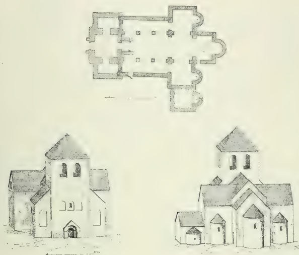
Fig. 30 a - c. Plan och perspektiv av den äldsta kyrkan med tillbyggt torn och gravkapell. Rekonstruktion.
